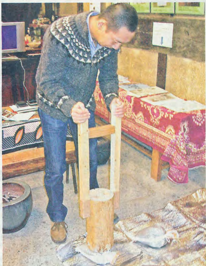
現地で使われる土のうを踏み固める道具 (京都市中京区)
